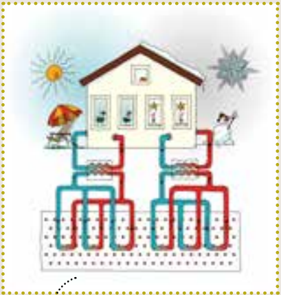
Werking individuele WKO met gesloten bodemplussen
